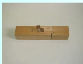
竿車知継（さおしゃちつぎ） 横に使う材木に用いる
