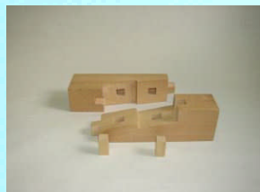
台持継（だいもちつぎ） 横に使う材木に用いる
