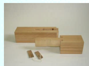
竿車知継（さおしゃちつぎ） 横に使う材木に用いる
